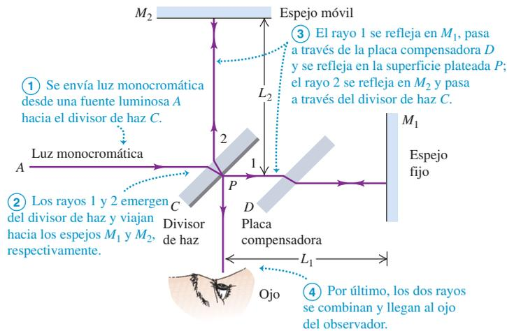
**35.20** Esquema del interferómetro de Michelson. El observador mira un patrón de interferencia que es resultado de la diferencia de las longitudes de las trayectorias de los rayos 1 y 2.
