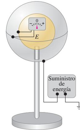
**22.27** Corte transversal de las partes esenciales de un generador electrostático Van de Graaff. El sumidero de electrones en la parte inferior los retira de la banda, lo que da a ésta una carga positiva; en la parte superior, la banda atrae electrones de la coraza conductora y le imparte una carga positiva.
