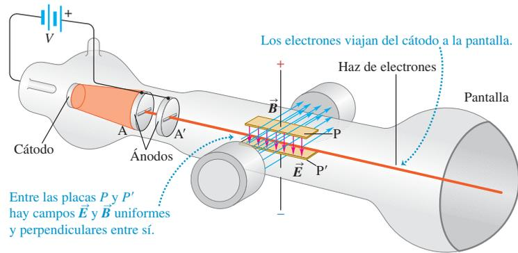
Los electrones pasan entre las placas P y P' y chocan contra la pantalla al final del tubo, que está recubierto de un material que emite fluorescencia (brilla) en el lugar del impacto. Cuando se satisface la ecuación (27.13), los electrones viajan en línea recta entre las placas; al combinar esto con la ecuación (27.14),
