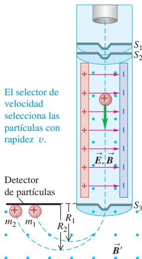
**Espectrómetros de masa**
