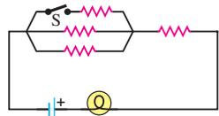
**P26.10.** Una batería real con resistencia interna que no es despreciable se conecta a través de una bombilla, como se indica en la figura 26.34. Cuando se cierra el interruptor S, ¿qué pasa con la luminosidad del foco? ¿Por qué?
