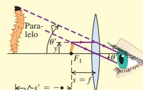
**Microscopios y telescopios:** En un microscopio compuesto, la lente objetivo forma una primera imagen en el cañón del instrumento, y el ocular forma una imagen virtual final, que suele hallarse en el infinito, de la primera imagen. El telescopio funciona con base en el mismo principio, pero el objeto está muy alejado. En un telescopio de reflexión, la lente objetivo se sustituye por un espejo cóncavo, el cual elimina las aberraciones cromáticas.
