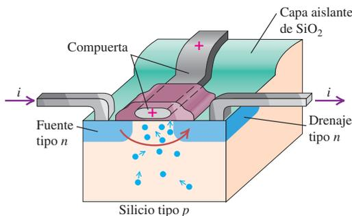
**42.37** Un transistor de efecto de campo. La corriente de la fuente al drenaje se controla con la diferencia de potencial entre fuente y drenaje, y por la carga en la compuerta. No pasa corriente por la compuerta.
