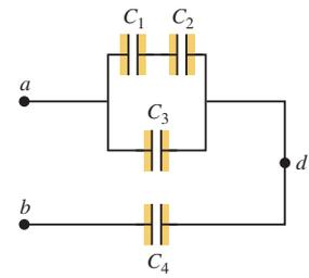
**24.16.** En la figura 24.8a, sean  $C_1 = 3.00 \mu\text{F}$ ,  $C_2 = 5.00 \mu\text{F}$  y  $V_{ab} = +52.0$  V. Calcule *a)* la carga en cada capacitor, y *b)* la diferencia de potencial a través de cada capacitor.
