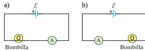
**P25.16.** (Véase la pregunta para análisis P25.14.) ¿Brillará más una bombilla cuando se conecta a una batería como se ilustra en la figura 25.32a, con un amperímetro ideal  $A$  colocado en el circuito, o cuando se conecta como se representa en la figura 25.32b, con un voltímetro ideal  $V$  colocado en el circuito? Explique su razonamiento.
