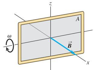
**29.51.** Como nuevo ingeniero electricista en la compañía de electricidad local, le asignaron el proyecto de diseñar un generador de voltaje ca sinusoidal con voltaje máximo de 120 V. Además de mucho alambre,
