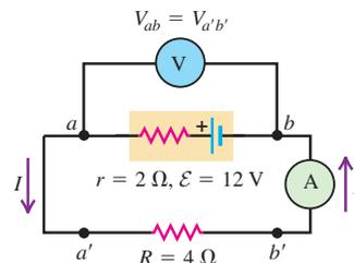
**EJECUTAR:** El amperímetro ideal tiene una resistencia igual a cero, por lo que la resistencia externa a la fuente es  $R = 4 \Omega$ . De la ecuación (25.16), la corriente a través del circuito  $aa'b'b$  es
