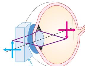
Esta lente cilíndrica se curva en la dirección vertical pero no en la horizontal, cambiando la distancia focal de los elementos verticales.
