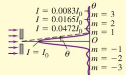
**Rejillas de difracción:** Una rejilla de difracción consiste en un gran número de ranuras finas paralelas, espaciadas una distancia  $d$ . La condición para que se alcance la intensidad máxima en el patrón de interferencia es la misma que en el caso del patrón de dos fuentes; pero los máximos producidos por la rejilla son muy marcados y angostos. (Véase el ejemplo 36.4.)
