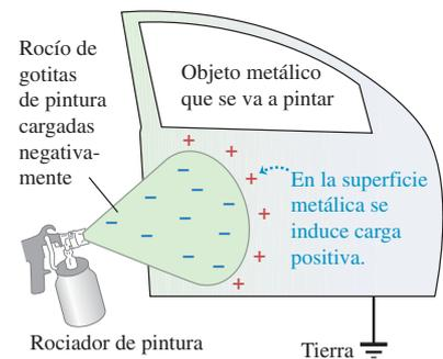
eléctrica conforme salen de la boquilla rociadora. Al acercarse las gotitas de pintura al objeto que se pinta, aparecen en éste cargas inducidas del signo opuesto, como se ilustra en la figura 21.7b, que atraen las gotitas a la superficie. Este proceso minimiza la formación de nubes de partículas dispersas de pintura y da un acabado particularmente liso.
