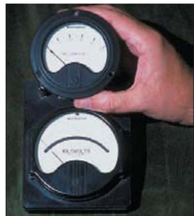
**26.14** Galvanómetro de d'Arsonval con una bobina de pivote o articulada a la que está adherida una aguja; un imán permanente suministra un campo magnético de magnitud uniforme, y el resorte proporciona un par de torsión restaurador que se opone al par de torsión del campo magnético.
