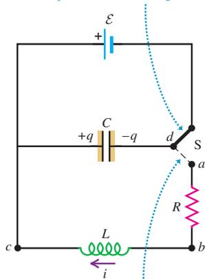
Cuando el interruptor  $S$  pasa a esta posición, el capacitor se descarga a través del resistor y el inductor.
