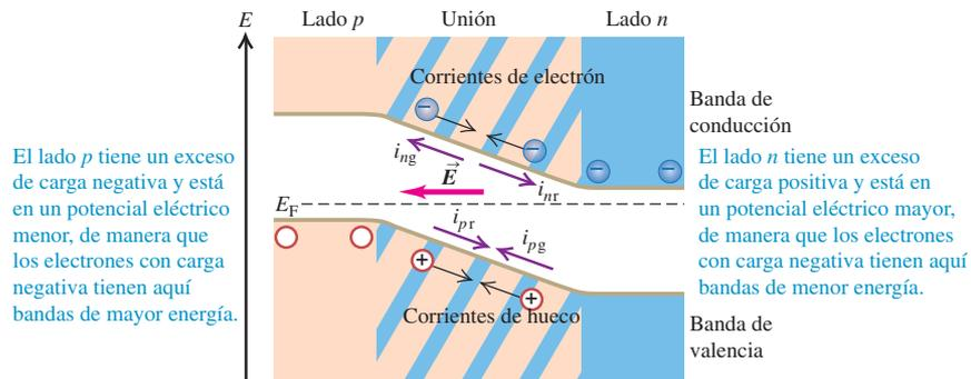
**42.33** Una unión  $p$ - $n$  bajo condiciones de polarización directa. La diferencia de potencial entre las regiones  $p$  y  $n$  se reduce, al igual que el campo eléctrico dentro de la unión. Las corrientes de recombinación aumentan, pero las de generación son casi constantes, causando una corriente neta de izquierda a derecha.
