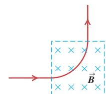
**27.25.** Un electrón del haz del cinescopio de un televisor es acelerado por una diferencia de potencial de 2.00 kV. Después pasa a través de una región de campo magnético transversal, donde se mueve en un arco circular con 0.180 m de radio. ¿Cuál es la magnitud del campo?
