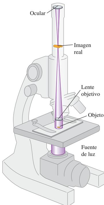
b) Óptica del microscopio
