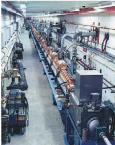
**23.13** Este acelerador en el Fermi National Accelerator Laboratory, en Illinois, da a los protones una energía cinética de 400 MeV ( $4 \times 10^8 \text{ eV}$ ). Las etapas adicionales de aceleración incrementan su energía cinética a 980 GeV, o 0.98 TeV ( $9.8 \times 10^{11} \text{ eV}$ ).
