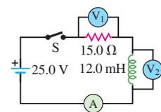
**30.65.** En el circuito que se aprecia en la figura 30.25, el interruptor *S* se cierra en el instante  $t = 0$ . *a)* Determine la lectura de cada instrumento de medición justo después de cerrar *S*. *b)* ¿Cuál es la lectura de cada instrumento mucho después de haber cerrado *S*?
