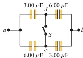
**24.60.** Los capacitores en la figura 24.33 se encuentran inicialmente sin carga y están conectados, como se ilustra en el diagrama, con el interruptor  $S$  abierto. La diferencia de potencial aplicada es  $V_{ab} = +210 \text{ V}$ . a) ¿Cuál es la diferencia de potencial  $V_{cd}$ ? b) ¿Cuál es la diferencia de potencial a través de cada capacitor una vez cerrado el interruptor  $S$ ? c) ¿Cuánta carga fluyó a través del interruptor cuando se cerró?
