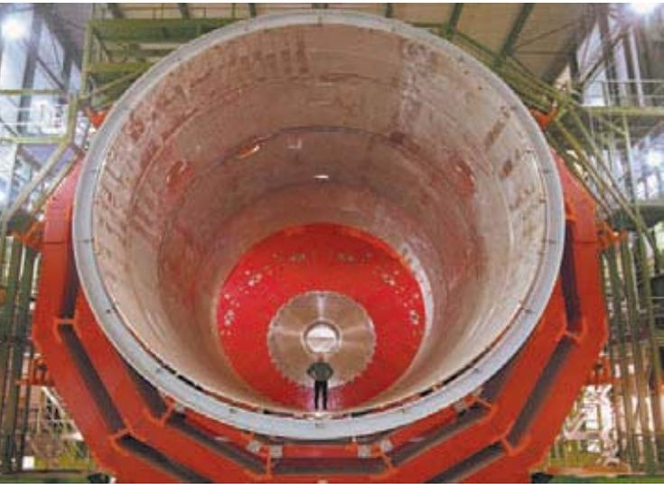
? El inmenso cilindro que aparece en esta fotografía, en realidad, es una bobina conductora de corriente, o solenoide, que genera un campo magnético uniforme en su interior, como parte de un experimento realizado en el Laboratorio Europeo para Física de Partículas (CERN). Si dos de tales solenoides se unieran por sus extremos, ¿qué tan fuerte sería el campo magnético?
