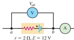
tería es igual a la fem. Por lo tanto, la lectura del voltímetro es  $V_{ab} = \mathcal{E} = 12$  V. El voltaje terminal de una fuente real, no ideal, es igual a la fem *sólo* si no hay corriente que fluya a través de la fuente, como en este ejemplo.
