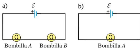
la figura 25.30a, las dos bombillas  $A$  y  $B$  son idénticas. En comparación con la bombilla  $A$ , ¿la bombilla  $B$  brilla más, igual o menos? Explique su razonamiento. *b)* Se retira la bombilla  $B$  del circuito y éste se completa como se ilustra en la figura 25.30b. En comparación con el brillo de la bombilla  $A$  en la figura 25.30a, ¿ahora la bombilla  $A$  brilla más, igual o menos? Explique su razonamiento.
