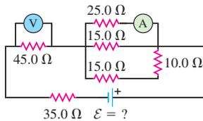
**26.7.** Para el circuito que se ilustra en la figura 26.41, determine la lectura del amperímetro ideal si la batería tiene una resistencia interna de  $3.26\ \Omega$ .
