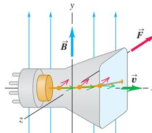
**27.9** Determinación de la dirección de un campo magnético usando un tubo de rayos catódicos. Como los electrones tienen carga negativa, la fuerza magnética  $\vec{F} = q\vec{v} \times \vec{B}$  en el inciso b) apunta en contra de la dirección dada por la regla de la mano derecha (véase la figura 27.7b).
