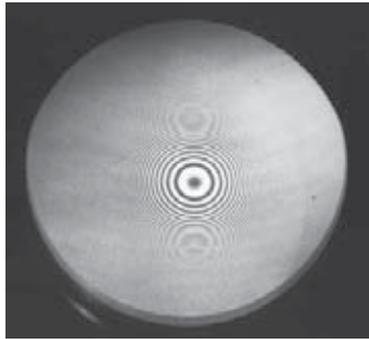
alta calidad se pulen con una precisión de menos de una longitud de onda. La superficie del espejo primario del telescopio espacial Hubble se pulió a una precisión de menos de  $\frac{1}{50}$  de longitud de onda. Por desgracia, se elaboró con especificaciones incorrectas, lo que generó uno de los errores “más precisos” en la historia de la tecnología óptica (véase la sección 34.2).
