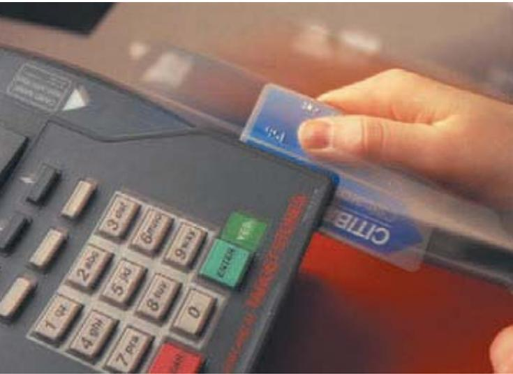
? Cuando una tarjeta de crédito se “desliza” por el lector, la información codificada en un patrón magnético al reverso de la tarjeta se transmite al banco del cuenta-habiente. ¿Por qué es necesario deslizar la tarjeta en vez de sostenerla inmóvil en la ranura del lector?
