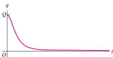
c) Circuito sobreamortiguado (resistencia  $R$  muy grande)
