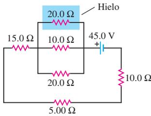
26.61. Calcule las tres corrientes  $I_1$ ,  $I_2$  e  $I_3$  que se indican en el diagrama de circuito en la figura 26.65.
