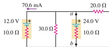
26.68. En el circuito que se ilustra en la figura 26.72, todos los resistores tienen potencia nominal máxima de  $1.00 \text{ W}$ . ¿Cuál es la fem  $\mathcal{E}$  máxima que la batería puede tener sin que se quemara ninguno de los resistores?
