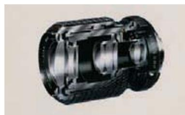
vector de cine, una lámpara ilumina la película, la cual actúa como objeto de la lente de proyección. La lente forma una imagen real, ampliada e invertida de la película sobre la pantalla de proyección. Debido a que la imagen es invertida, la película pasa por el proyector de cabeza para que la imagen aparezca en la pantalla derecha.
