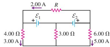
**26.24.** En el circuito que se ilustra en la figura 26.52, obtenga *a*) la corriente en cada ramal y *b*) la diferencia de potencial  $V_{ab}$  del punto  $a$  en relación con el punto  $b$ .
