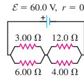
**26.12.** Calcule la resistencia equivalente de la red de la figura 26.43, y determine la corriente en cada resistor. La batería tiene una resistencia interna despreciable.
