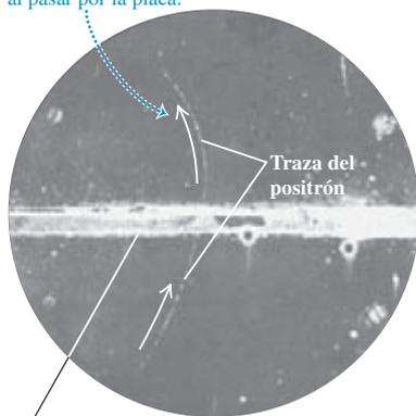
La placa de plomo tiene 6 mm de espesor
