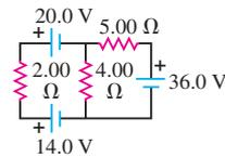
26.64. a) Encuentre la corriente a través de la batería y de cada uno de los resistores en el circuito ilustrado en la figura 26.68. b) ¿Cuál es la resistencia equivalente de la red de resistores?
