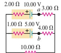
**26.25.** La batería de  $10.00\ \text{V}$  de la figura 26.52 se retira del circuito y se vuelve a colocar con la polaridad opuesta, de manera que ahora su terminal positiva está junto al punto  $a$ . El resto del circuito queda como en la figura. Encuentre *a*) la corriente en cada ramal y *b*) la diferencia de potencial  $V_{ab}$  del punto  $a$  con respecto al punto  $b$ .
