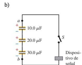
Cuando se acciona el interruptor  $S$ , fluye una oleada de carga desde los capacitores que se descargan, la cual activa el dispositivo de señal. ¿Cuánta carga fluye a través del dispositivo de señal?
