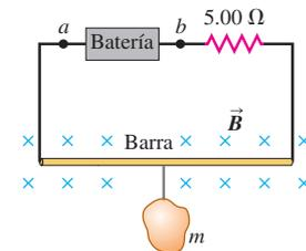
magnética sobre la barra. Un resistor con  $R = 5.00 \Omega$  está en serie con la barra; la resistencia del resto del circuito es mucho menor que esto. a) ¿Cuál punto,  $a$  o  $b$ , debería ser la terminal positiva de la batería? b) Si el voltaje terminal máximo de la batería es de 175 V, ¿cuál es la masa más grande  $m$  que este instrumento es capaz de medir?
