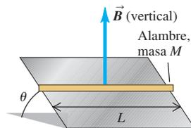
**27.68.** Una barra metálica de 3.00 N y 1.50 m de longitud tiene una resistencia de  $10.0 \Omega$  y descansa horizontal sobre alambres conductores que la conectan al circuito de la figura 27.62. La barra está en un campo magnético uniforme horizontal de 1.60 T, y no está sujeta a los alambres del circuito. ¿Cuál es la aceleración de la barra justo después de que se cierra el interruptor  $S$ ?
