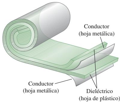
La mayoría de los capacitores tienen un material no conductor o **dieléctrico** entre sus placas conductoras. Un tipo común de capacitor emplea tiras largas de hojas (láminas) metálicas como placas, separadas por tiras de hojas de materiales plásticos, como Mylar. Estos materiales dispuestos en forma de emparedado se enrollan para formar una unidad capaz de proveer una capacitancia de varios microfarads en un paquete compacto (figura 24.13).
