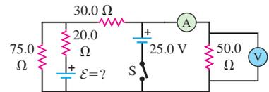
**26.28.** En el circuito que se muestra en la figura 26.54, ambas baterías tienen resistencia interna insignificante y el amperímetro ideal lee  $1.50\ \text{A}$  en el sentido que se ilustra. Encuentre la fem  $\mathcal{E}$  de la batería. ¿Es correcta la polaridad que se indica?
