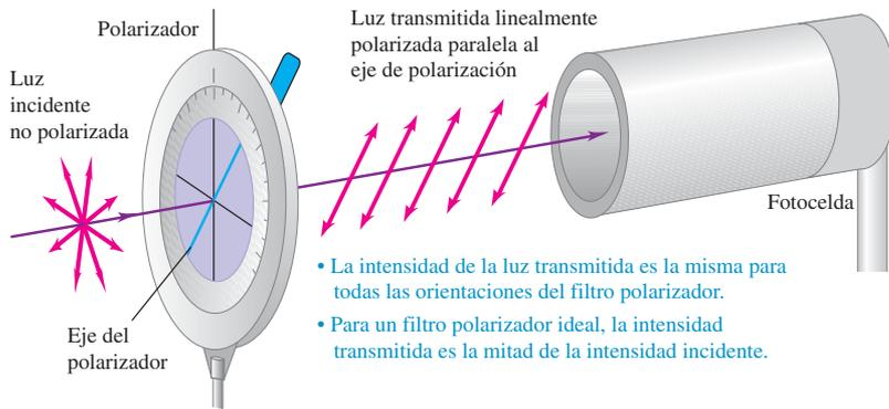
**33.24** La luz natural no polarizada incide sobre el filtro no polarizador. La fotocelda (o celda fotovoltaica) mide la intensidad de la luz linealmente polarizada que se transmite.
