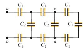
**24.64.** Cada combinación de capacitores entre los puntos  $a$  y  $b$  en la figura 24.35 se conecta primero a través de una batería de  $120 \text{ V}$ , para cargar la combinación a  $120 \text{ V}$ . Después, estas combinaciones se conectan para formar el circuito que se ilustra.
