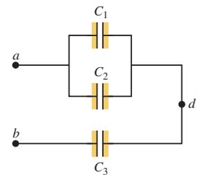
**24.19.** En la figura 24.26,  $C_1 = 3.00 \mu\text{F}$  y  $V_{ab} = 120$  V. La carga en el capacitor  $C_1$  es  $150 \mu\text{C}$ . Calcule el voltaje a través de los otros dos capacitores.
