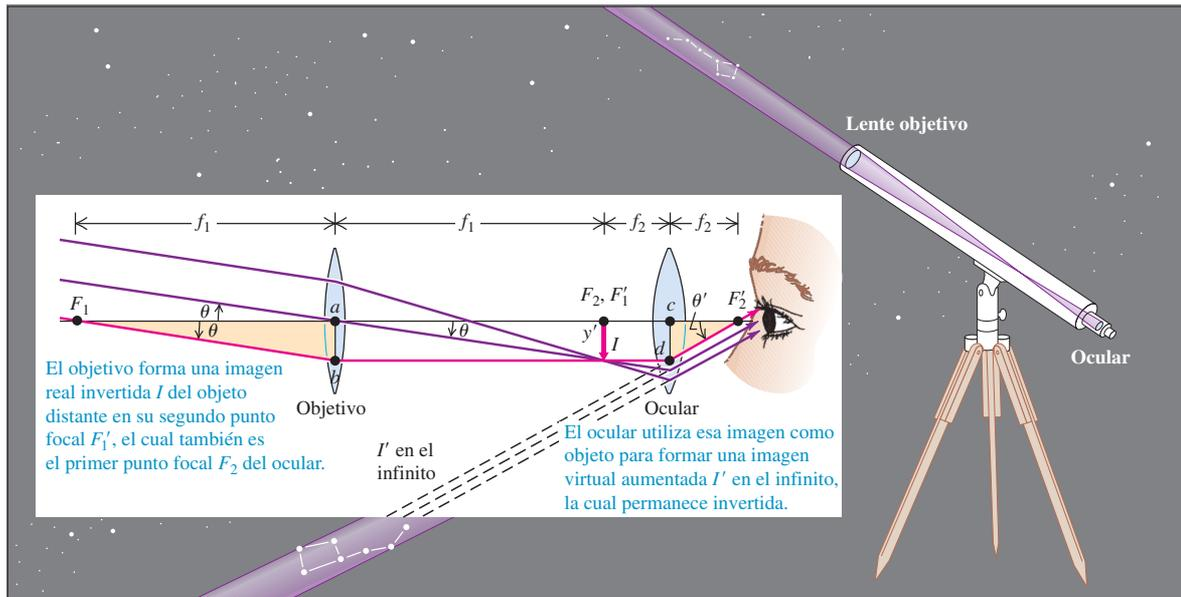
lente objetivo. Si la imagen final  $I'$  formada por el ocular se halla en el infinito (para ser vista con la máxima comodidad por un ojo normal), la primera imagen también debe estar en el primer punto focal del ocular. La distancia entre objetivo y ocular, que es la longitud del telescopio, es por ende la *suma* de las distancias focales del objetivo y del ocular:  $f_1 + f_2$ .
